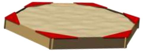
Доски крепятся на полиамидные уголки. Полиамидные уголки должны закрываться полиамидной крышкой для исключения откручивания и для защиты резьбовой части крепежа, а также обеспечения безопасности для находящихся на изделии.
